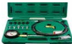
Se usa para medir la presión de la bomba y del sistema de lubricación del motor.
