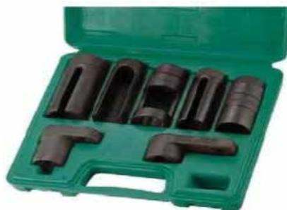
Diseñados especialmente para remover y colocar sensores de oxígeno sin dañar los cables ni la cerámica.
