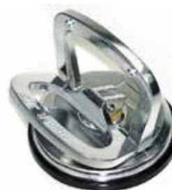
Su material de goma, permite adherirse a vidrios, mármol, granito o cualquier elemento de superficie lisa, así como partes de carrocería. Se usa para sujetar y trasladar: parabrisas, ventanas o fragmentos metálicos sin dejar marcas dactilares. Diámetro (Ø): 123mm
