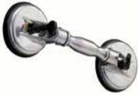
Su material de goma, permite adherirse a vidrios, mármol, granito o cualquier elemento de superficie lisa, así como partes de carrocería. Se usa para sujetar y trasladar: parabrisas, ventanas o fragmentos metálicos sin dejar marcas dactilares. Capacidad de carga: 35Kg.
