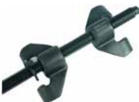
Sirve para comprimir y mantener los resortes en espiral mientras se cambian los amortiguadores.
