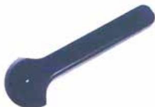
Fabricado en material resistente con mango largo y cabeza semicircular de 95mm con bisel en el borde, que puede penetrar en aberturas estrechas para reformar los paneles dañados. Cabeza: 3,1/2" (95mm). Longitud: 11" (280mm)
