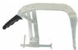
Sirve para prensar los resortes de las válvulas permitiendo remover o colocar los seguros de las válvulas. Solo con cabezote removido del block.
