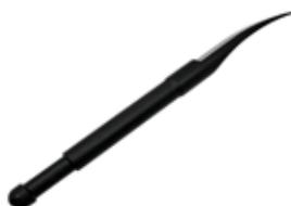
Se usa para desabollar partes de carrocería sin acceso para yunques o sufrideras y palancas.
