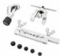
Sirve para cortar las cañerías metálicas y abocardar las puntas para facilitar el sellado cónico.
