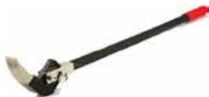
Permite detectar las fugas de suspensión (daños de cauchos, bocines, rodamientos, etc).
