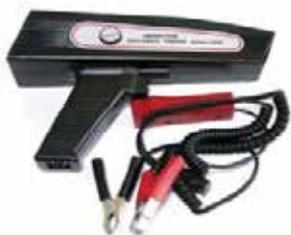
Se usa para medir el avance del motor, también mide el voltaje del sistema eléctrico y las revoluciones del motor.
