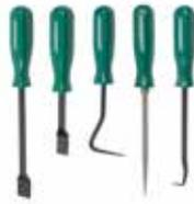
Se usa para sujetar partes de la carrocería que la mano no puede sostener, los rascadores permiten retirar pintura o demás materiales blandos en áreas pequeñas.
