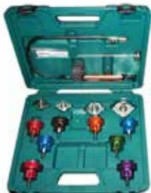
Sirve para detectar fugas de refrigerante en todo el sistema con el vehículo frío.
