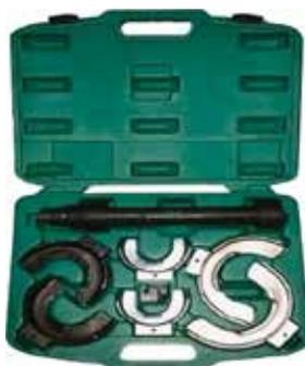
Sirve para comprimir y mantener los resortes en espiral mientras se cambian los amortiguadores.
