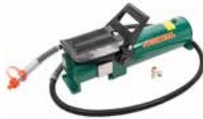
Se usa como ayuda en cualquier herramienta o sistema que funcione con presión hidráulica.
