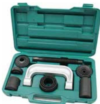
Permite retirar e instalar juntas universales y pasadores de anclaje de forma fácil
