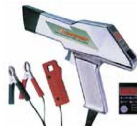
Se usa para medir el avance del motor, también mide el voltaje del sistema eléctrico y las revoluciones del motor .
