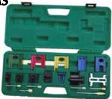
Ideal para no perder la sincronización original del vehículo. Compatible con motores de diseño especial, ejemplo: renault, volkswagen, honda, entre otros.
