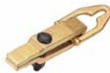
Se usa para sujetar partes de la carrocería o compacto cuando se los va a enderezar con un sistema hidráulico o en una cama de enderezado.
