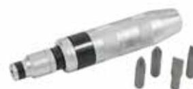
Se usa para retirar tornillos con las cabezas semidestruidas o cuando el tornillo esta presionado por la carrocería producto de una abolladura.
