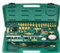
Sirve para medir la presión del sistema de combustible en vehículos a gasolina.
