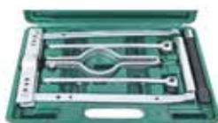
Sirve para extraer los rodamientos al interior de la transmisión, permiten la remoción de rodamientos en partes profundas de la coraza.
