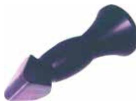
Fabricado en material resistente con doble extremo; el primero en forma redonda convexa de 70mm, mientras que el segundo, en flecha con punta curvada 65mm. Ideal para trabajar en paneles de chapa más livianos, proporcionando un efecto de amortiguación para igualar el peso del martillo sin extensión. Extremo redondo convexo: 2.3/4" (70mm). Extremo de flecha: 2.1/2" (65mm). Longitud: 7" (180mm)
