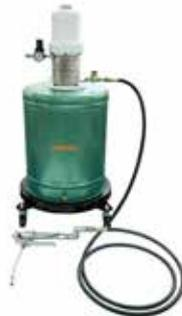
Se utiliza durante los trabajos de mantenimiento en unidades, conjuntos y mecanismos de automóviles, máquinas, herramientas y equipos tecnológicos.
