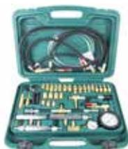
Sirve para medir la presión del sistema de combustible en vehículos a gasolina.
