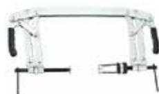
Sirve para prensar los resortes de las válvulas permitiendo remover o colocar los seguros de las válvulas.
