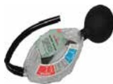
Sirve para determinar el estado del electrolito de las baterías.
