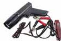
Se usa para medir el avance del motor.
